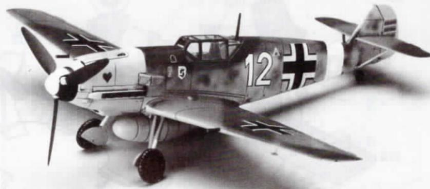
Bf109E-4/7は、バトル・オブ・ブリテン以後F型が登場するまでドイツ空軍の主力戦闘機として北は極寒のノルウェーから南は熱砂の北アフリカまでヨーロッパのあらゆる戦場で活躍しました。E-4は、基本的にE-3と同じですがキャノピーが角型の新タイプになっています。また、E-7はE-4の長距離戦闘機タイプで、胴体下に300リットル増槽が懸吊できるラックが装備されている他
