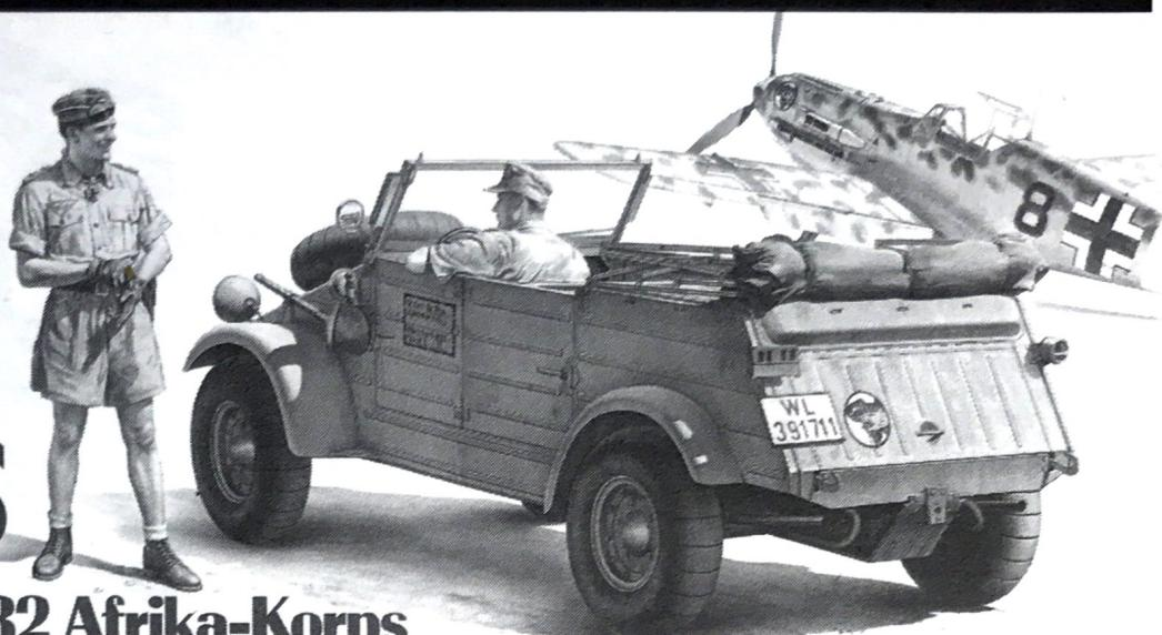
の要望に基づき、砂漠での走行性を高めるために幅の広いバルーンタイヤを装備したアフリカ仕様が生産開始。1943年5月のアフリカ戦線終了後も一部がイタリア戦線で使用されました。キューベルワーゲンは終戦までに50,000輌以上を生産、タイヤの形やリヤフェンダー、エンジンのアンダーガード、方向指示器やサイドミラーの位置、排気管のレイアウトなど生産時期によって細かな違いが見られました。
