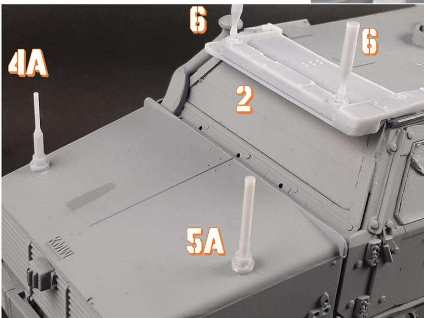
Dachträger (2) erst „trocken“ anlegen. Sitz überprüfen und evtl. die darunter liegende Verschraubung Bausatzseitig entfernen. Danach Antennen anpassen und wie dargestellt anbringen. Kabelkanal „trocken“ anlegen und anpassen. Danach fest verbinden. 4A und 5A erkennbar an den Schrägen Antennenfüßen. Trocken anlegen und anpassen, danach befestigen
