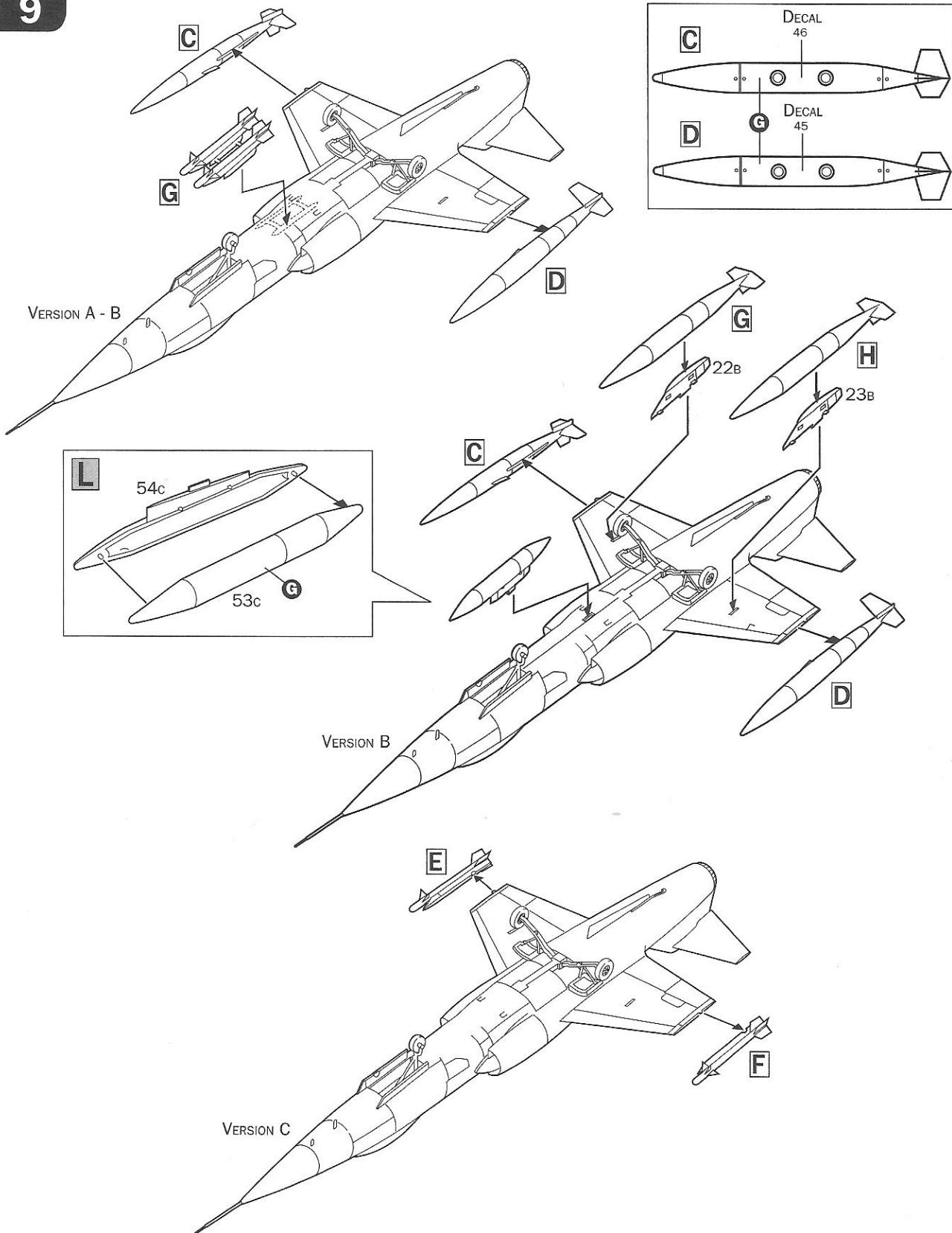
Istruzioni per l'applicazione delle decalcomanie. Ritagliare le decalcomanie occorrenti dal foglio, immergerle in un bicchiere di acqua pulita per circa 10°, metterle in posizione sul modello e farle scivolare dalla carta: per una migliore aderenza comprimerle con una pezzuola pulita.
