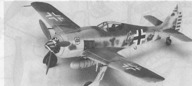
Fw190はMe109の補助戦闘機として開発され、歐州機としては、珍しく空冷エンジンを装備した機体です。頑丈な機体にして高い運動性、それを可能にした合理的な設計。改修を重ねつつ大戦を経て一線機であり続けました。A-5は、A-0以降の改修で重心が変わった為、機首を前方への型です。A-8は、Aシリーズの決定版といえる機体で、全型式を通じて最高の約8,300機も造されました。派生型も
