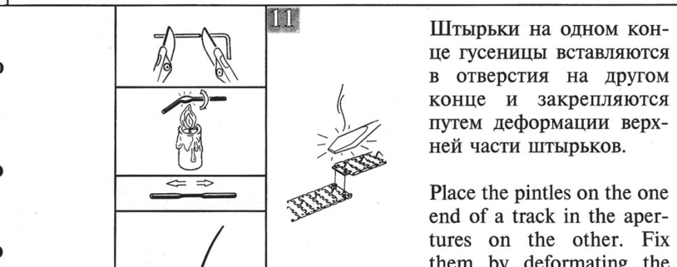
Штырьки на одном конце гусеницы вставляются в отверстия на другом конце и закрепляются путем деформации верхней части штырьков.
