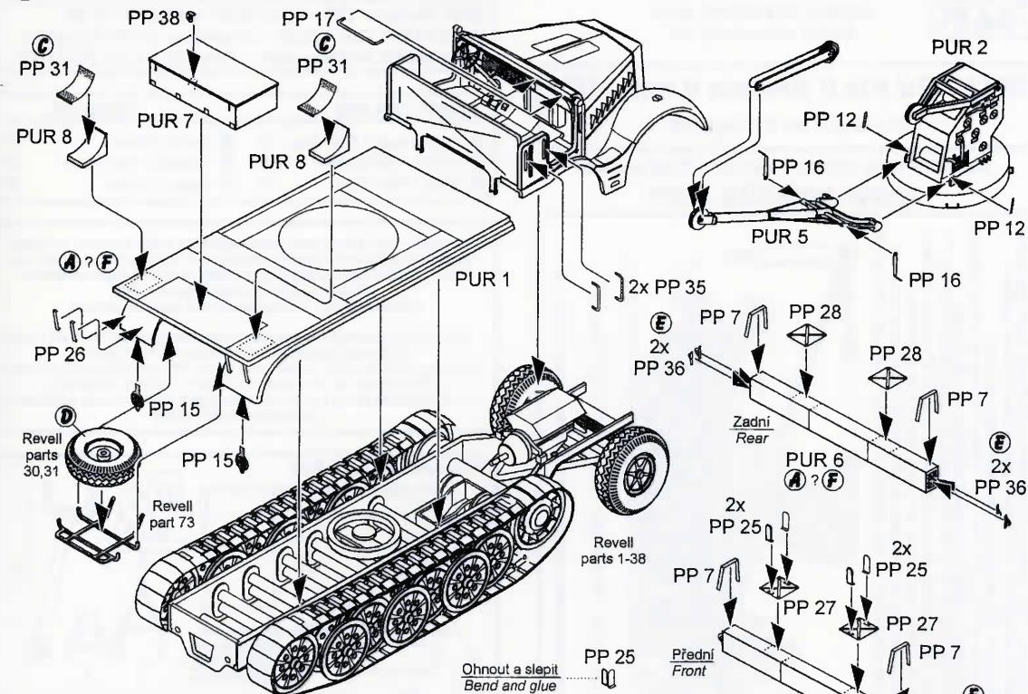
**5 Montáž detailů vozidla / Mounting of vehicle details**
