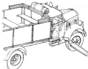
**Attenzione:** montare gli sportelli senza incollarli, e muoverli soltanto a cabina finita, incidendo con una lama sottile l'angolo indicato nella figura in alto. Lo spessore sottile della plastica renderà possibile l'apertura e la chiusura degli sportelli per diverse volte senza rompersi.
