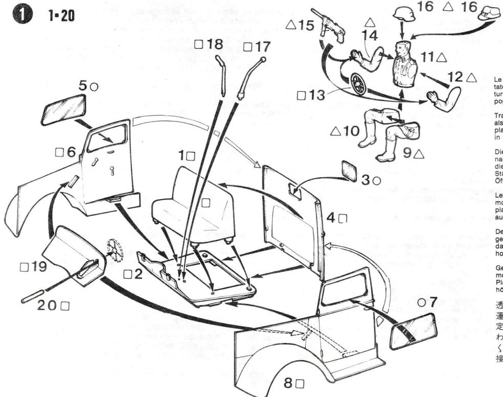
Le parti trasparenti possono essere montate anche per ultime dopo la verniciatura applicandole contro gli appositi appoggi agli angoli dell'apertura.
