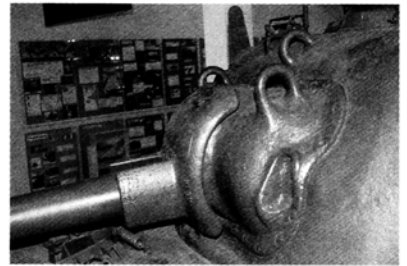
実車のM34砲架です。同軸機銃は取り外されています。車体はM4初期型。
