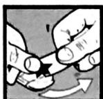
Anweisungen für Abziehbilder-Anbringung: Die benötigten Abziehbilder vom Blatt abscheiden, in ein Glas reines Wasser für etwa 10° eintauchen, auf das Modell legen und dann vom Papierbogen abnehmen. Um eine bessere Haftung zu erzielen, die Abziehbilder mit einem reinen Tuch andrücken.
