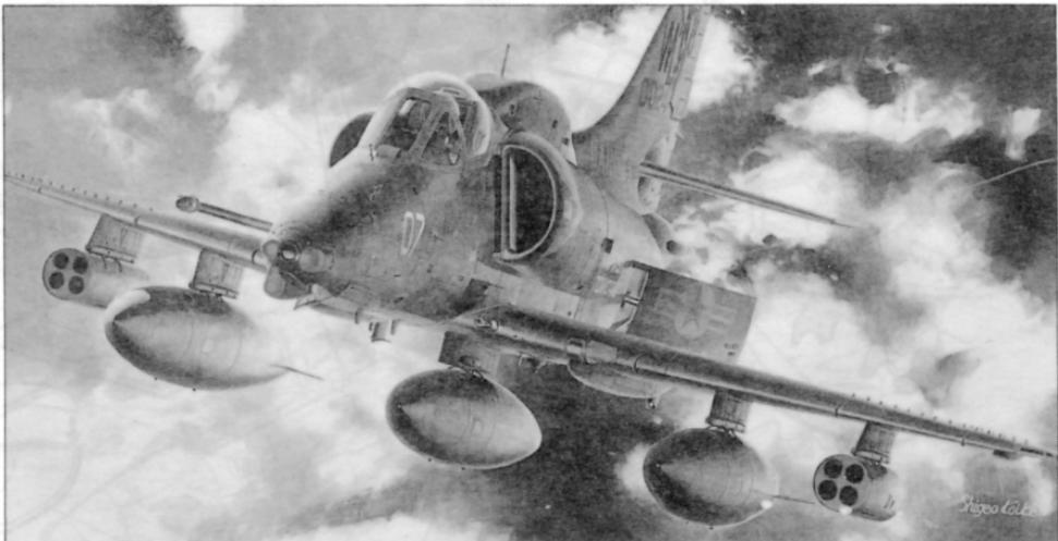
A-4Mは、米海兵隊向けに、A-4初期型の発達型として開発された機体です。エンジンはより強力なP&W J52-P-408Aに換装され、軽量小型の機体は一段と運動性が向上しました。さらにキヤノピーの大型化、慣性航法システムの装備などにより全天候型に対応できる能力をもっています。1970年4月に原型機が初飛行し、翌年4月から量産型がVMA-324に配備されました。
