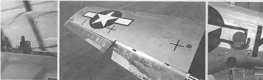
●写真偵察機型のF-6D。撮影角度調整用に十字のマークがキャノピーと左主翼上面に描かれている。
