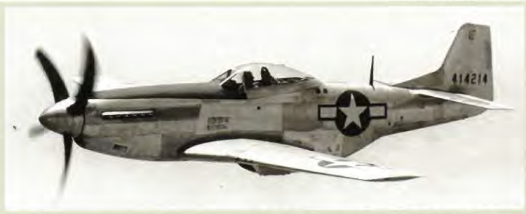
●水滴形キャノピーを採用し、武装を強化したP-51D。
