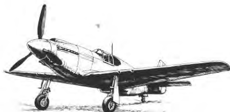
● NA-73X。層流翼など革新的な技術を導入していた。 The NA-73X incorporated revolutionary features such as a laminar flow wing.
