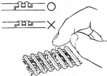
If track broken, strengthen with staplers or thread. Bei Kettenbruch mit Heftklammern oder Draht flicken.
