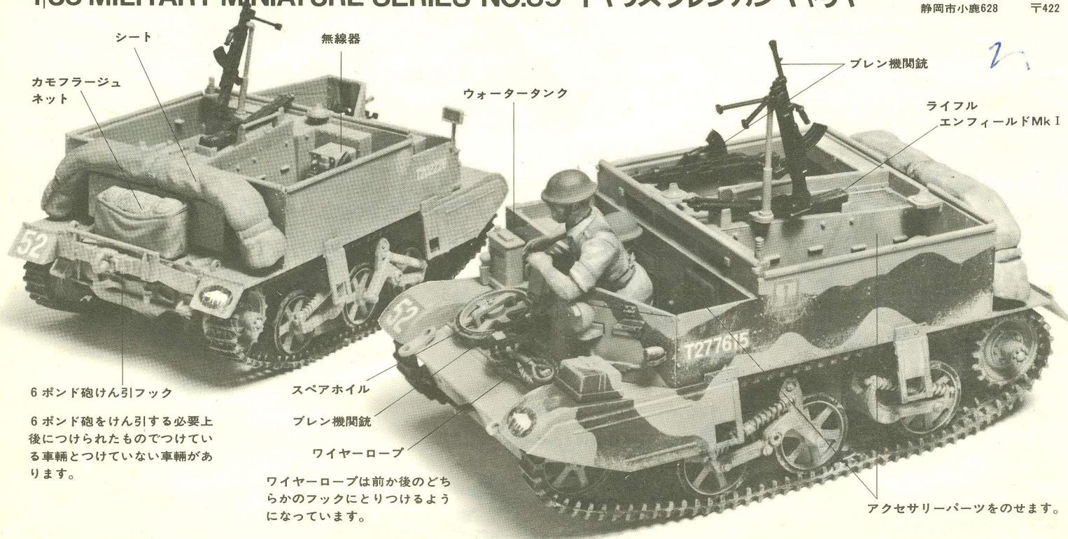
第2次大戦のイギリスおよびイギリス連邦軍は、各種のキャリヤー（運搬車）と呼ばれる軽キャタピラー車を多用途かつ大量に使用しました。これらのキャリヤーは、一般にひとまとめにしてブレンガン・キャリヤーと呼ばれていますが、これはブレン機関銃を搭載して歩兵支援用に開発されたブレンガン・キャリヤーの名が、そのままこの一連のキャリヤーのニックネームとなってしまったもので、実際に最も大量に生産され、多方面に使われて代表的な存在となったのが、多用途運搬車ユニバーサル・キャリヤーでした。
