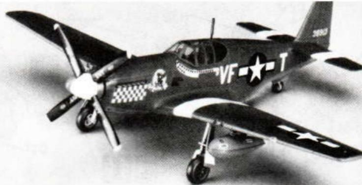
P-51ムスタングは、1940年4月にイギリス航空機購入委員会がノースアメリカン社と交わした契約により、117日という驚異的なスピードで開発された戦闘機です。当初イギリスに輸出されましたが、アメリカが参戦するとP-51に冷淡だったアメリカ陸軍航空隊にも採用されました。B/C型は、P-51A型に搭載していたアリソンV-1710V型液冷12気筒エンジン（アメリカ製）を、パッカード・マーリンV-1650V型液
