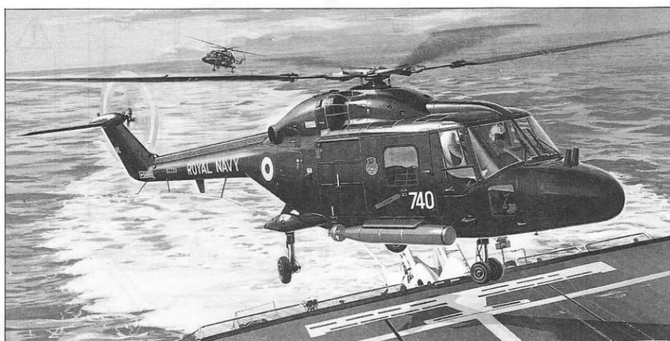
ウエストランドリンクスは英仏両軍の中型多用途機を目標に開発された双発タービンヘリコプターです。胴体は軽量化のためにグラスファイバー材が多用に使われています。英仏海軍用では降着装置が前輪式の3車輪であり、潜水艦探地識別装置のほかにホーミング魚雷を装備できます。
