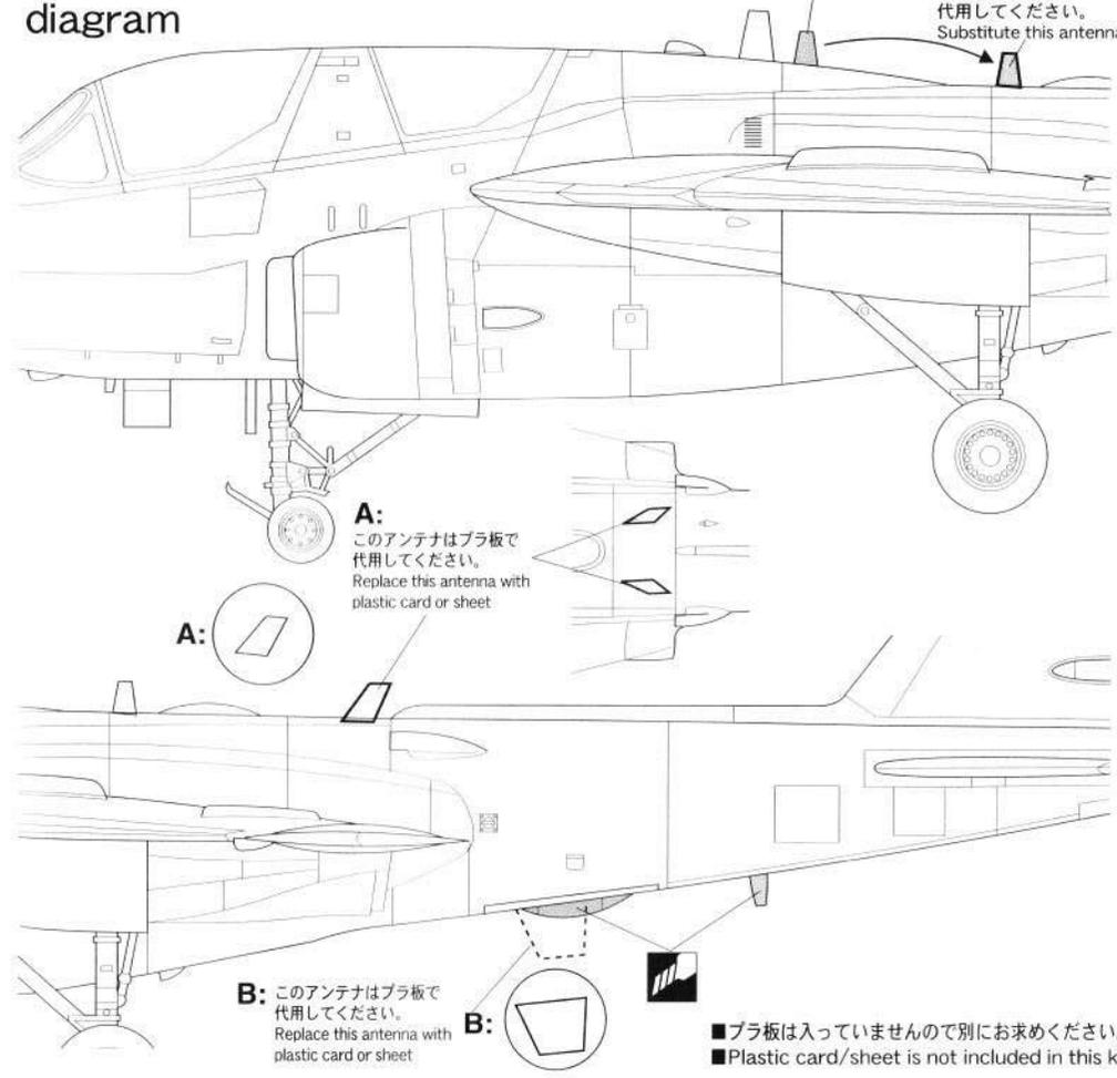
**A:** このアンテナはプラ板で代用してください。 Replace this antenna with plastic card or sheet
