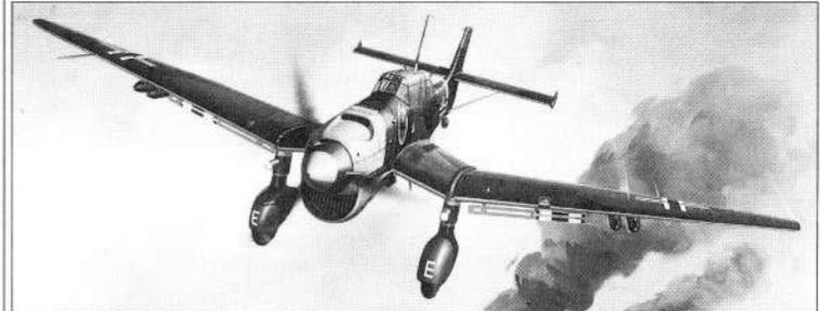
ドイツ空軍は、アラド、ハインケル、ユンカース、ハンブルグ製作所(後のプローム・ウント・フォス)の4社に急降下爆撃機の試作契約を行ない、比較審査の結果ユンカースJu87に決定した。スツーカー(STURZ-KAMPFLUGZEUG,略してSTUKA)の誕生である。Ju87は1937年より本格量産型A-1の生産が始まった。パワー不足のA型から、エンジンなどを強化したB型にかわるのに時間はかからなかった。B型はA型の主翼と水平尾翼を除き他は再設計である。エンジン出力が向上したため、乗員2名で500kg爆弾を搭載できるようになり、250kg爆弾を搭載した場合は翼下面に50kg爆弾4発を積み込むことが可能になった。R型は洋上作戦専用の遠距離型で、B型の外翼内にタンクを増設し、翼下面に落下増槽をつけたものである。
