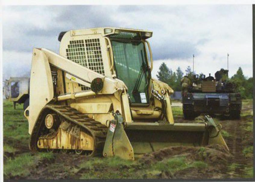
**繁體中文** 自從JCB挖掘機被開發出來以後，民用工地建築上使用的設備尺寸不斷縮小，以提高機動性並能進入更小的作業空間。雖然最初主要設計用於民用，但小型滑移轉向和緊湊型履帶裝載機的概念也被證明對軍事用戶具有吸引力，M400T(履帶)及其輪式的M400W兄弟就是最好的例子。
