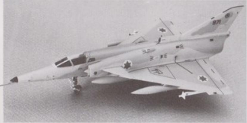
I.A.I.クフィールC2は、フランスのデルタ翼戦闘機ミラージュ5を基本として、イスラエルが開発した超音速ジェット戦闘機です。エンジンをアター9CからアメリカのGE-J79に換装してパワーアップをはかり、エアインテーク後方にカナード翼を配置して、運動性能も向上しています。また、操縦装置をフライバイワイヤ方式とするなど最新の技術を取り入れています。
