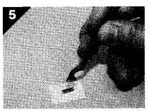
**⑤**図の様にしてパッドを接着します。 Cement the pad as shown in the diagram.
