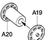
●エナメル線を図のようにリールの端に瞬間接着剤で止めます。乾燥後、使用する長さに応じて巻いてください。
