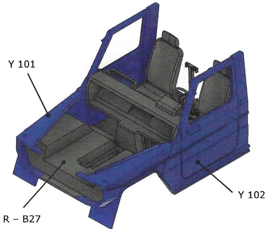
Vor dem Verkleben der beiden Seitenpanelen (Y 101) und (Y 102) mit der Bodengruppe (R - B27) sollte eine trockene Passprobe durchgeführt werden.
