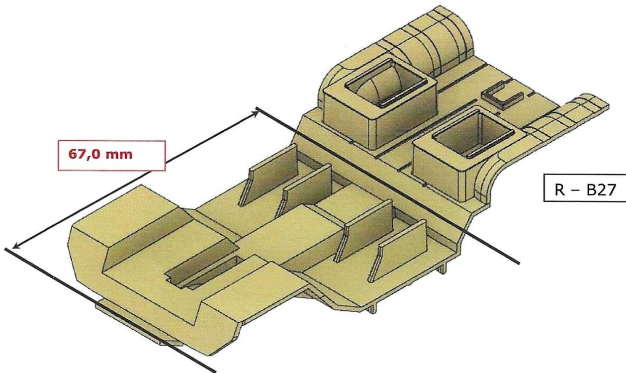
Bodengruppe (R - B27) an der schwarz gekennzeichneten Linie exakt 90° mit einer Resinsäge in zwei Teile auftrennen. Hinterer Teil wird nicht mehr benötigt.
