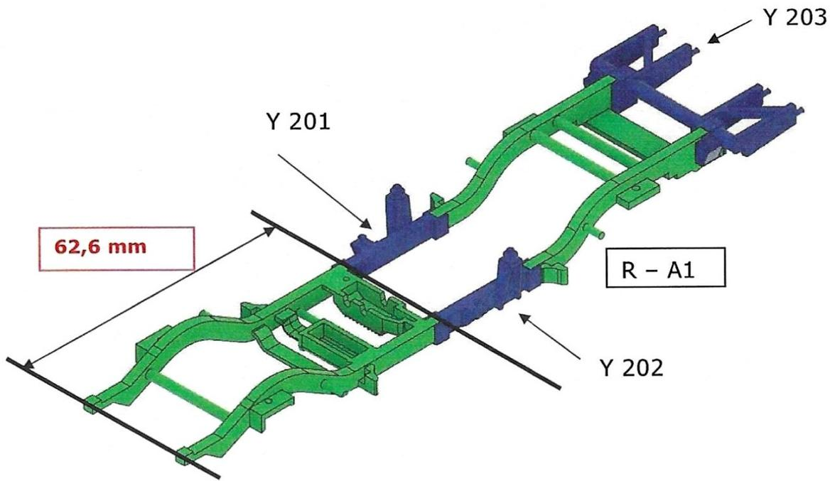
Rahmen (R - A1) an der schwarz gekennzeichneten Linie exakt 90° mit einer Resinsäge in zwei Teile auftrennen.
