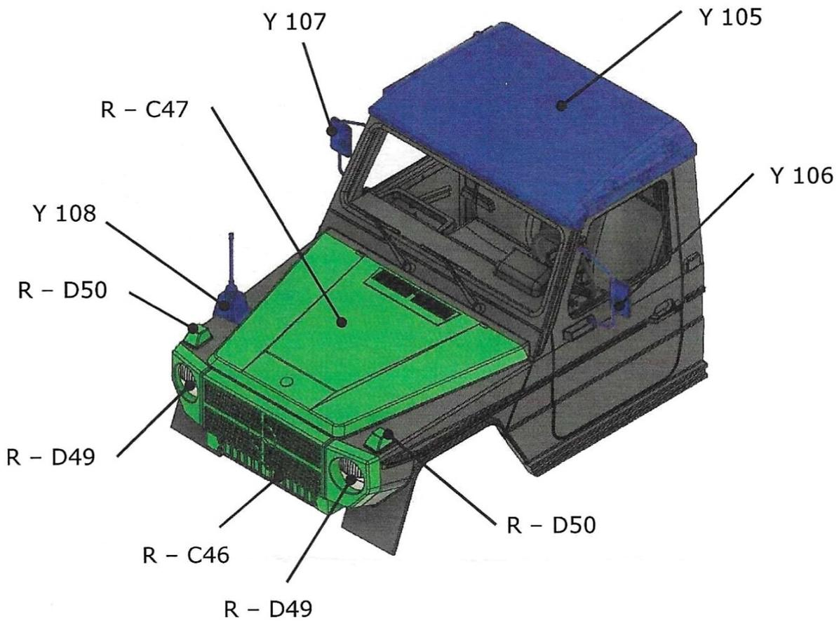
Die zwei Bohrungen in der Motorhaube (R - C47) verschließen.
