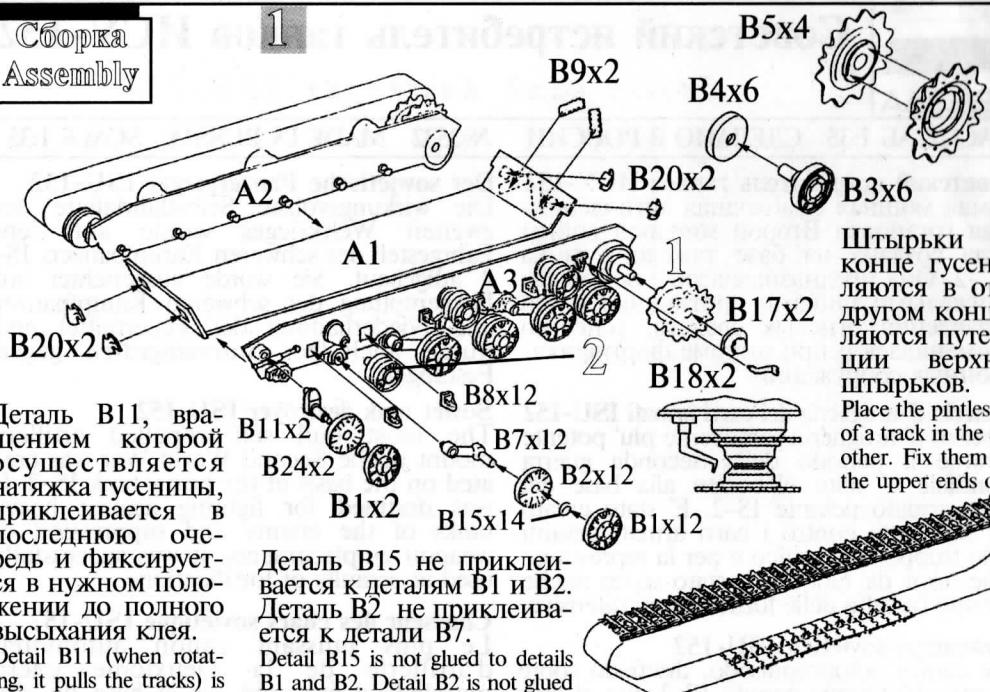
Деталь B11, вращением которой осуществляется натяжка гусеницы, приклеивается в последнюю очередь и фиксируется в нужном положении до полного высыхания клея.
