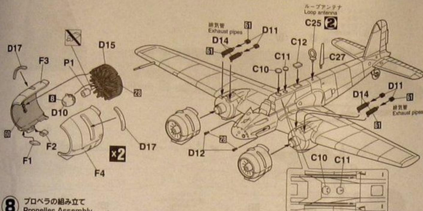
8 プロペラの組み立て Propeller Assembly
