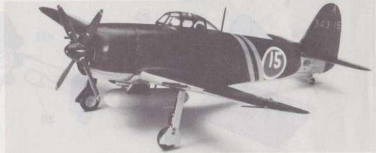
紫電改は、日本海軍戦闘機の禿尾を飾るにふさわしい傑作戦闘機です。前作紫電が中翼配置であるため、視界不良や長大な脚のトラブルに悩まれたのを、胴体を全面的に再設計して低翼配置としこれを解消、性能的にも紫電をはるかに上回った戦闘機となりました。紫電改は松山基地の343空に重点的に配備され、呉軍港を中心とした西日本各地の防空戦闘に活躍しています。
