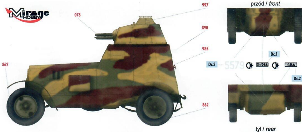
Samochód pancerny wz. 34-II uzbrojony w działko Puteaux SA 18 w malowaniu maskującym wprowadzonym w 1936 roku. Mk 1934-II armoured car armed with Puteaux SA 18 cannon in the camouflage scheme introduced in 1936.
