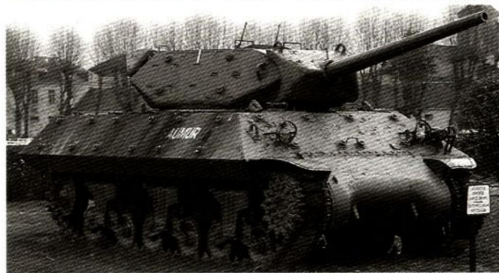
関しては避弾経始が良好な分、装甲防御力はある程度補われているといえるでしょう。また不足する装甲を補うため、必要に応じて増加装甲が追加できるように、車体上部の前面と側面、砲塔側面には、特徴的な六角ナットの取り付け部があらかじめ設けられていました。車体下部は走行装置も含めて、基本的に原型のM4A2と同一でした。ただし装甲厚は車体上部同様削られていて、側面・後面ともに25.4mm、床面はすべて12.7mmでした。
