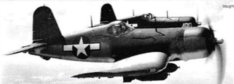
●編隊を組み飛行する初期型のF4U-1D、フレームのあるセミパブル型キャノピーを装備している。
