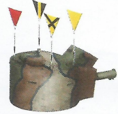
Rozmieszczenie chorągiewek sygnalizacyjnych na czołgu 7TP dwunieżowym (lewa wieża) Rysunek za zgodą Janka Jędryki Location of signal flags on the twin-turret 7TP tank (left turret).
