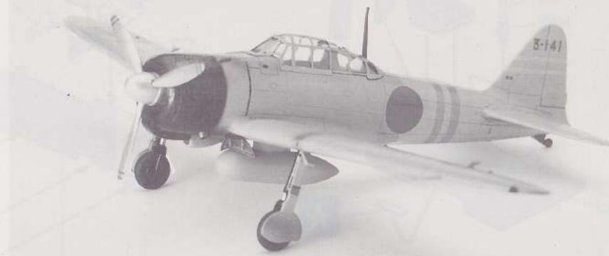
零式艦上戦闘機は、昭和15年夏から終戦までの5年間、日本海軍の盛衰と共に開いた戦闘機です。空戦性能が抜群で他の性能も当時の陸上戦闘機を凌ぐほどでした。11型は、陸上戦闘機として使われた為、着艦フックやクリンクル投射装置等が装備されていません。21型は艦上戦闘機とする為、11型では省略した装備を施し、翼端を500mmずつ上に折り畳むようにしました。32型は、高空性能の向上、横の操縦性の向上等を目的とした改良型です。
