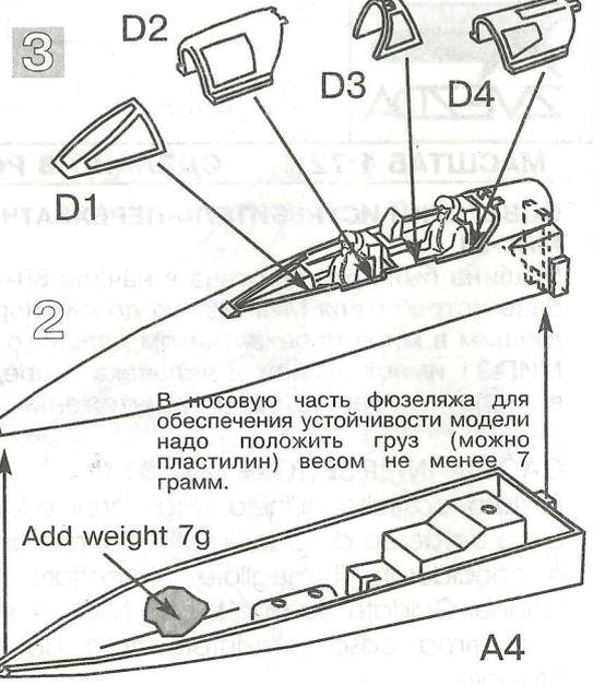
В носовую часть фюзеляжа для обеспечения устойчивости модели надо положить груз (можно пластилин) весом не менее 7 грамм.
