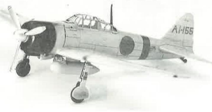
零式艦上戦闘機は、昭和15年夏から終戦までの5年間、日本海軍の盛衰と共に翻ひ抜いた戦闘機です。空戦性能が抜群で他の性能も当時の陸上戦闘機を凌ぐほどでした。11型は、陸上戦闘機として使われた為、着艦フックやクルシード投射方位測定装置等が装備されていません。21型は艦上戦闘機とする為、11型では省略した装備を施し、翼端を500mmずつに折り畳むようにしました。32型は、高空性能の向上、横の操縦性の向上等を目的とした改良型です。
