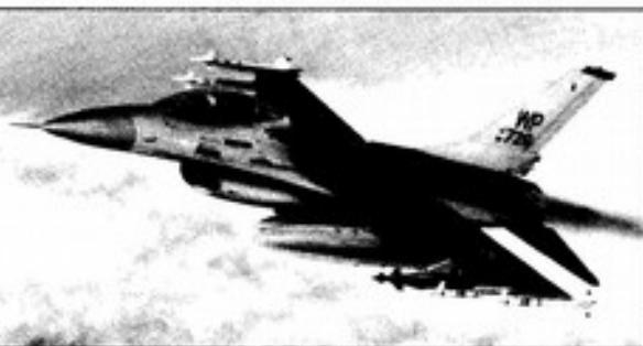
F16はジェネラル・ダイナミックス社が空軍の補助的な空戦戦闘機として開発したYF16（試作機）を実用大型化した機体で、単座のF16Aの1号機は1976年12月8日、B型の最初の機体は、1977年8月8日に初飛行した。この機体は小型ながら高性能で搭載能力が大きく、F15の約1/2という価格などの特性が高く評価され、F4と交替するよう編成が始まった。米空軍用ではブロック1、5、10の総計で329機、以後ブロック15、20からはF16A/Bプラスの機体で785機が生産され、海外受注を加えると総機数3000機を越えるものとなる。F16の特長は水滴型キャノピーで視認性にすぐれ、空戦、対地攻撃用にも充分なものであり、また、胴体下面に配置されたエンジン空気取入れ口は常に安定した空気流入を確保できるように工夫されている。量産前期型と量産後期型の大きな違いはスタビライザーの面積が約30%拡大されている点で、戦闘爆撃機としての機能も発揮できるように改修されている。最初に実戦で使われた例は、イスラエル空軍が1981年6月7日にイラクのオシラク原子炉を8機編隊で攻撃している。
