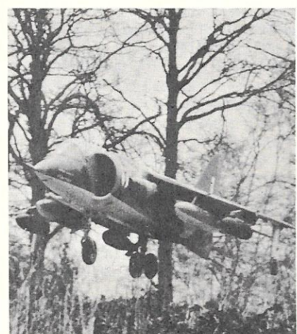
平後方より下方94°まで回転し推力の方向を変え上昇飛行から、水平飛行に変えるベクタードスラスト方式(Vectored Thrust)のV/STOL機(Vertical Short Take off Landing)で、推力8600kgのペガサス6エンジンを装備
