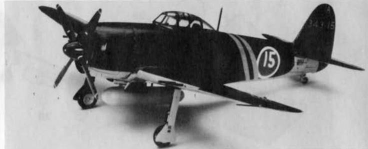
紫電改は、日本海軍戦闘機の掉尾を飾るにふさわしい傑作戦闘機です。前作紫電が中翼配置であるため、視界不良や長大な脚のトラブルに悩まされたのを、胴体を全面的に再設計して低翼配置としこれを解消、性能的にも紫電をはるかに上回った戦闘機となりました。紫電改は松山基地の343空に重点的に配備され、呉軍港を中心とした西日本各地の防空戦闘に活躍しています。
