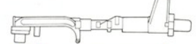
左主脚 ..... ×1 Left main gear strut Fahrwerkbein links Jambe de train principal gauche
